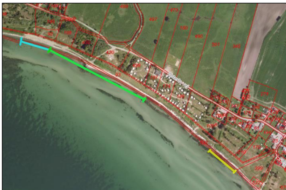
Figur 5. Flyfoto fra 2010 af en del af diget på matrikel nr. 93, Sønderby, Kegnæs. Den lyseblå linje viser den strækning, hvor der jf. flyfoto er arbejdet på diget i 2010. Den grønne linje viser den strækning, hvor der er arbejdet på diget i 2008. Den gule linje viser, hvor der er fjernet hybenbuske og etableret skråningsbeskyttelse.
