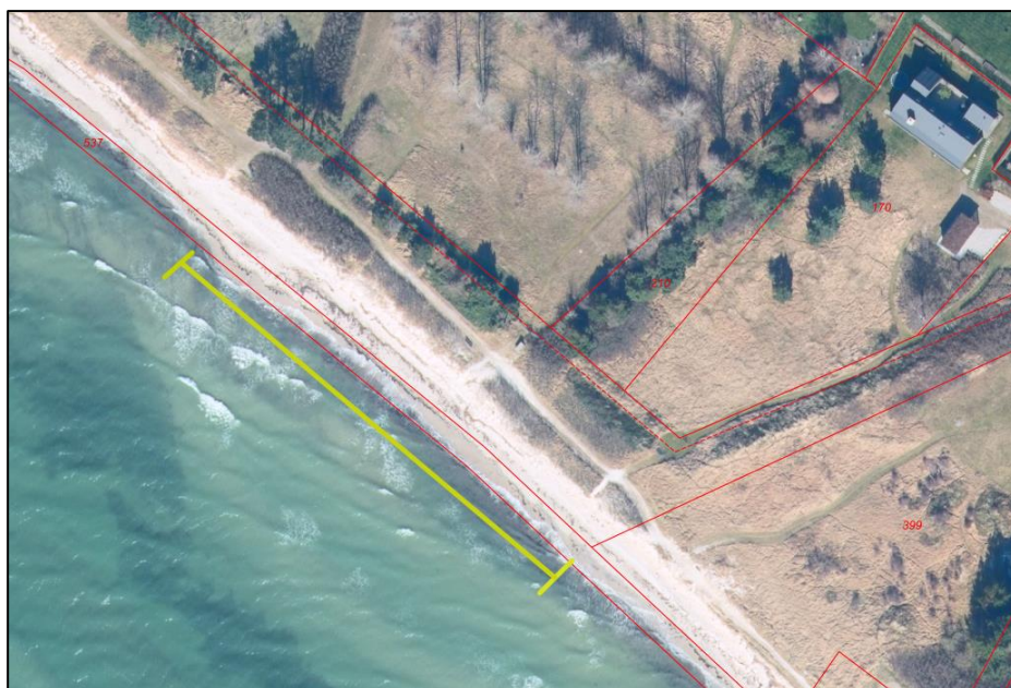
Figur 7. Flyfoto fra 2022 af en del af diget på matrikel nr. 93, Sønderby, Kegnæs. Den gule linje viser, hvor der er fjernet hybenbuske og etableret skråningsbeskyttelse. Se figur 6 for sammenligning med flyfoto fra 2023.
